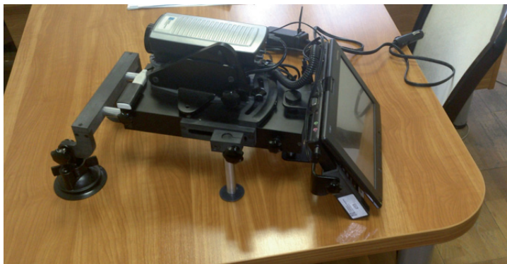
4. ábra. A jármű belsejében elhelyezendő mérőegység.
