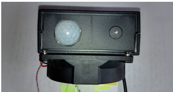
5. ábra. not2b v0.2 hátul nézet (balra Arduino USB kábel, jobbra UV LED-ek és a forgatóegység vezetékei).
