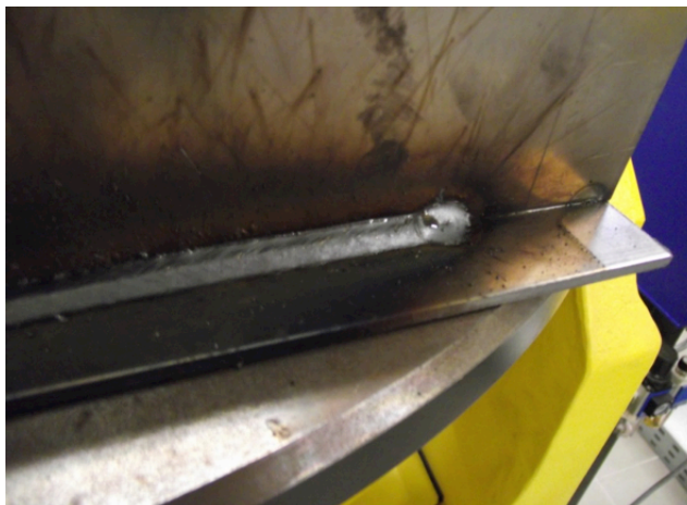
6. ábra. KF-Puls impulzushegesztési eljárással készített sarokvarrat (saját illusztráció).
