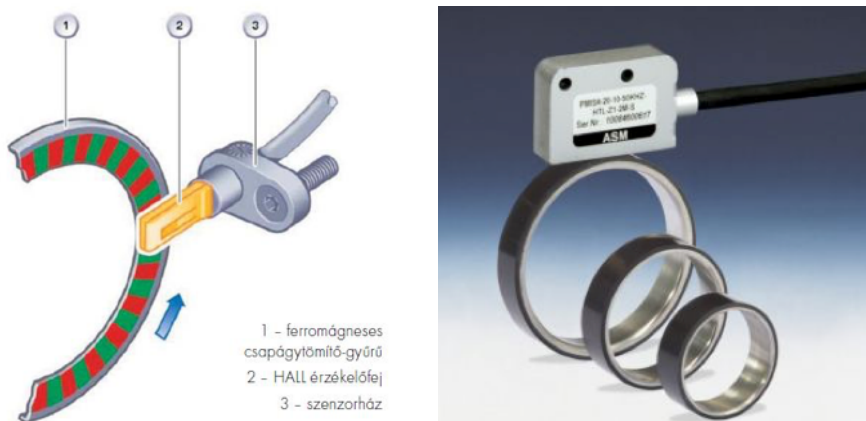
4. ábra. Mágneses gyűrű szöghelyzet-jeladó / ASM PMIR7 mágneses enkóder-gyűrű és PMIS4 enkóder fej.
