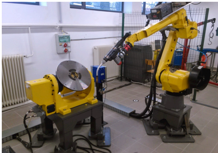
1. ábra. ArcMate 120iC/10L hegesztőrobot és a hozzá tartozó munkapad (saját illusztráció).
