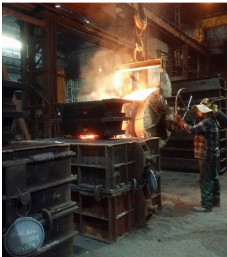
2. ábra. Öntés formaszekrénybe. Az atmoszférikus viszonyok alatti oxidáció és párolgás hatására a kezelőszerszám hatása lassan megszűnik.
