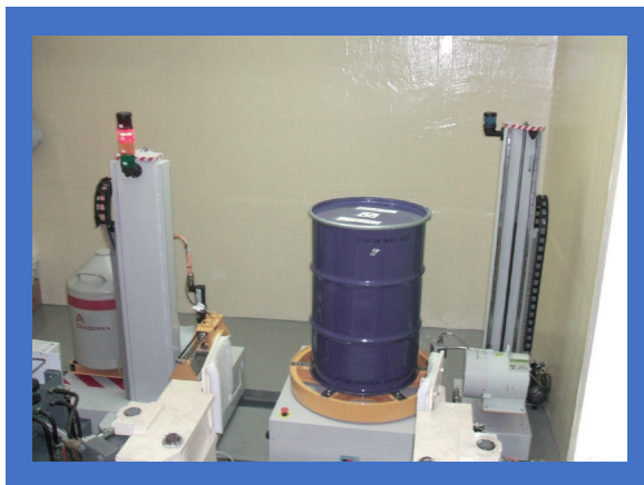
29. ábra. Hordószkenner berendezés [20]
