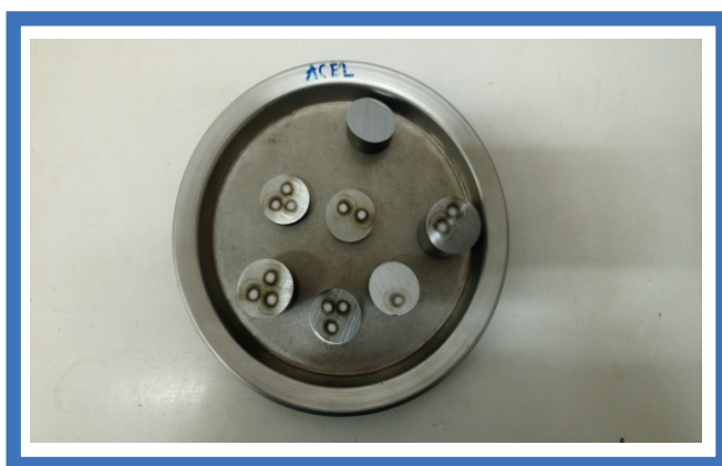
14–21. ábra. Szikragerjesztéssel létrehozott jellegzetes szikrafoltok tanúsított acélminták felületén
