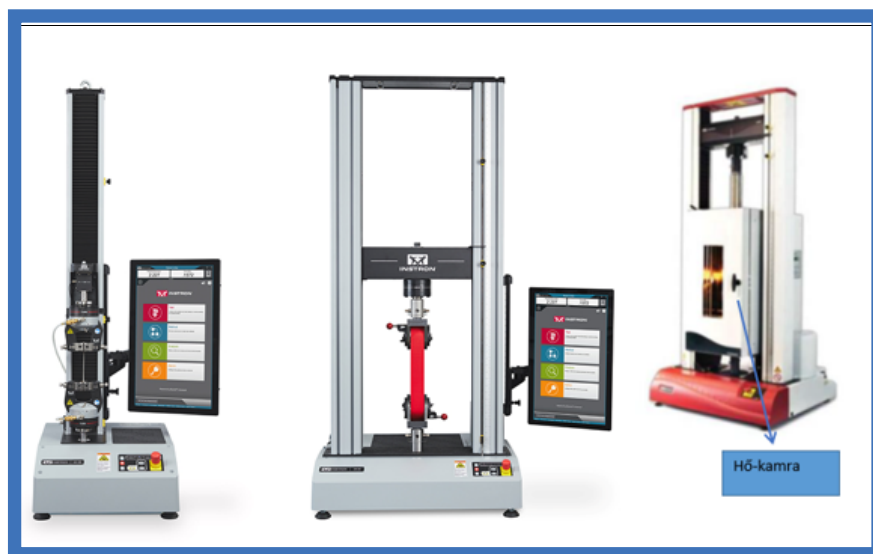
3–5. ábra. Korszerű szakítógépek egyoszlopos és kétoszlopos kivitelben és hőkamrával
