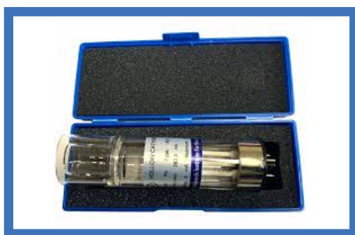
14–11. ábra. Üreges vájtkatód lámpa
