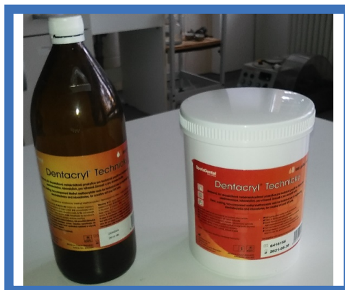
1–31. ábra. Kétkomponensű hideg beágyazó gyanta (folyadék+por)
