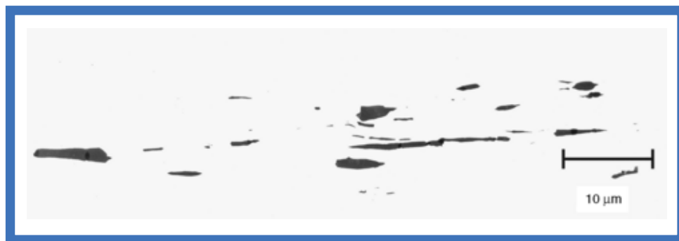
1–53. ábra. Szilikázzárvány acélban; (átvéve: [20])
