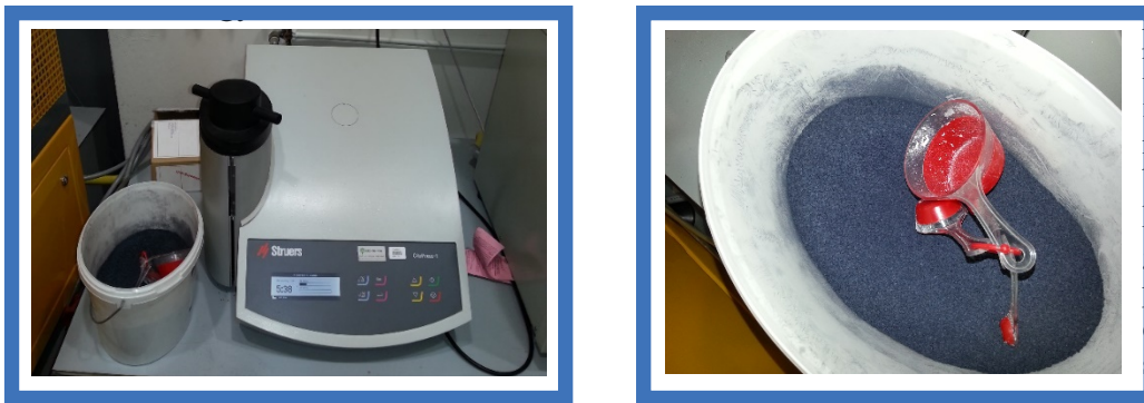
1–32. ábra. Melegbeágyazó gép – melegbeágyazó polimer granulátum
