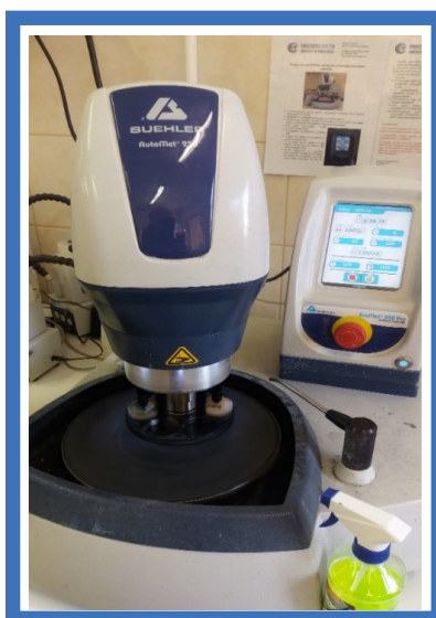
1–35. ábra. Gépi csiszolás leszorító tappancsokkal
