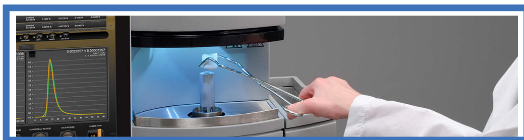
14–9. ábra. LECO 844 típusú C-, S-elemző készülék – kemencetér és szoftver [22]
