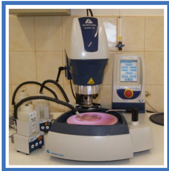
1–36. ábra. Automata polírozó gép – kenőfolyadék adagolóval
