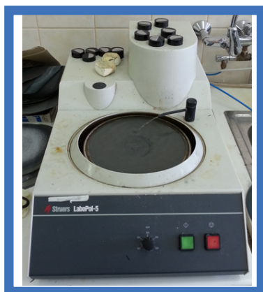
1–34. ábra. Kézi egytárcsás és kéttárcsás csiszoló valamint csiszoló-polírozó gépek
