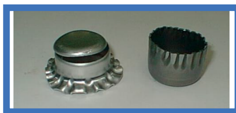
12–10. ábra. Mélyhúzási hibák: ráncosodás
