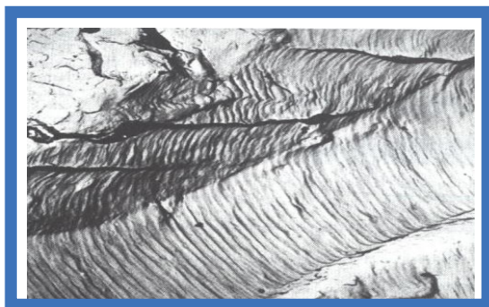
5–9. ábra. Jellegzetes fáradásos töret
