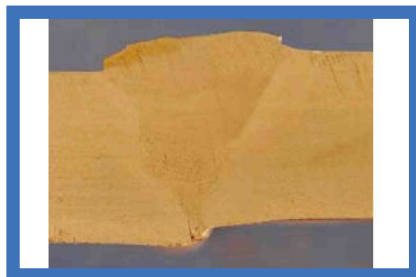
4.48. ábra. Párhuzamos éleltolódás és összeolvadási hiány a varratgyökben egy hegesztett kötés metszeti képén
