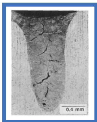
7.10. ábra. Kristályosodási repedés lézerhegesztéssel készített varratban
