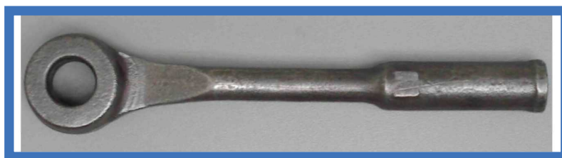
4.26. ábra. Gyűrődések kovácsdarabon
