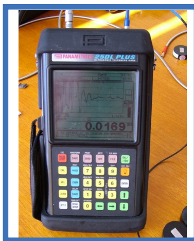
A kijelzőn látható mért érték 0.0169" (0,429 mm)
