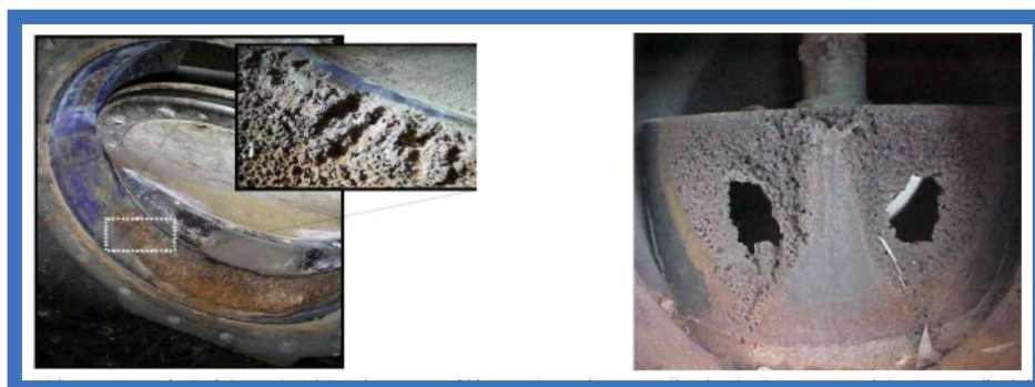
4.56. ábra. Kavitációs sérülések egy pillangószelepen (balra) és egy tolózárón (jobbra)
