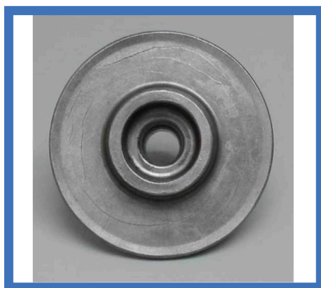
4.28. ábra. Kovácsolás okozta repedések
