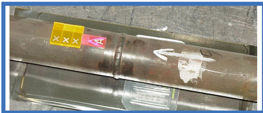
5.30. ábra. Az IQI elhelyezése a besugárzáshoz, ellipszis felvétel esetén (film oldal)
