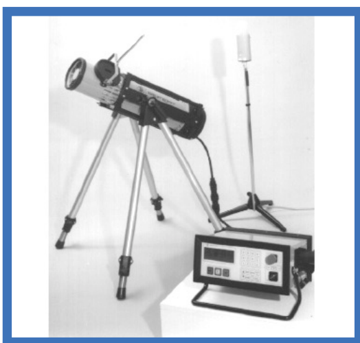
3.49. ábra. Egytankos, középfrekvenciás, állandó feszültségű berendezés, 200 kV
