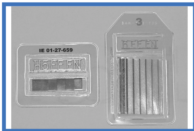
5.20. ábra. Huzalsoros és lépcsős/furatos típusú képmínőség-jelzők, az MSZ EN ISO 19232-1 és az MSZ EN ISO 19232-2 szabvány szerint
