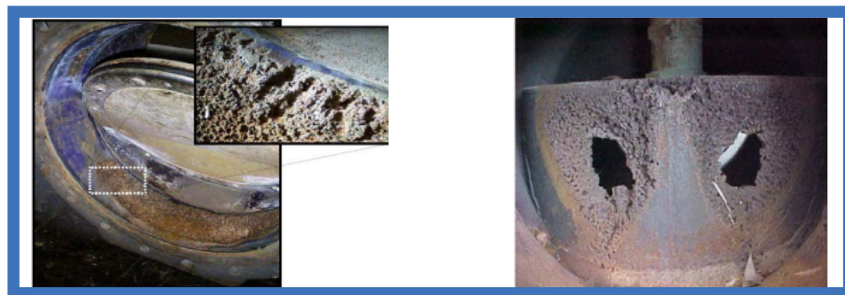
4.56. ábra. Kavitációs sérülések egy pillangószelepen (balra) és egy tolózárón (jobbra)
