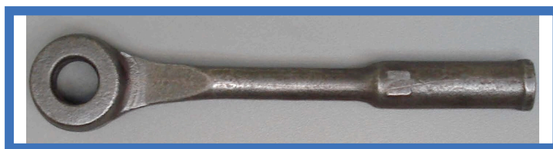
4.26. ábra. Gyűrődések kovácsdarabon
