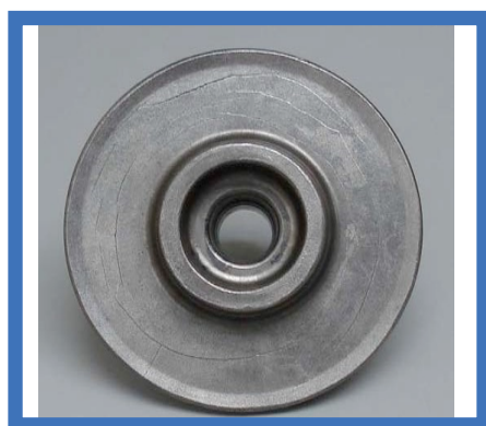
4.28. ábra. Kovácsolás okozta repedések
