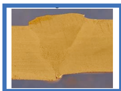
4.48. ábra. Párhuzamos éleltolódás és összeolvadási hiány a varratgyökben egy hegesztett kötés metszeti képen
