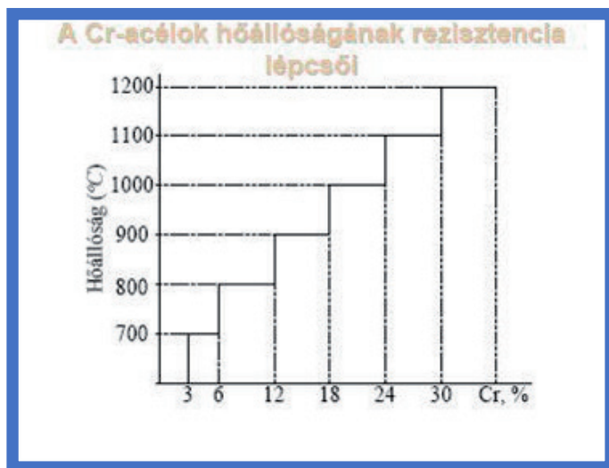
2.15.18. ábra. Hőállóság a krómtartalom függvényében
