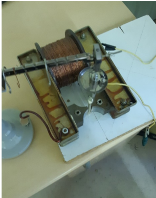
1. ábra. Az elektromágnes nagy indukciójú részének kialakítása
