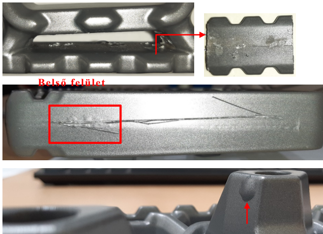
1. ábra. A mintadarabok felületén tapasztalható jellemző korróziós jelenségek
