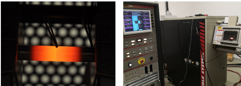
1. ábra. Diffúziós hegesztési kísérlet a Dunaújvárosi Egyetem Gleeble 3800-as termomechanikus szimulátorán
