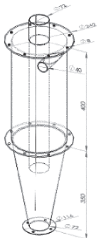
3. ábra. A por és gáz egyidejű leválasztásához használt ciklon
